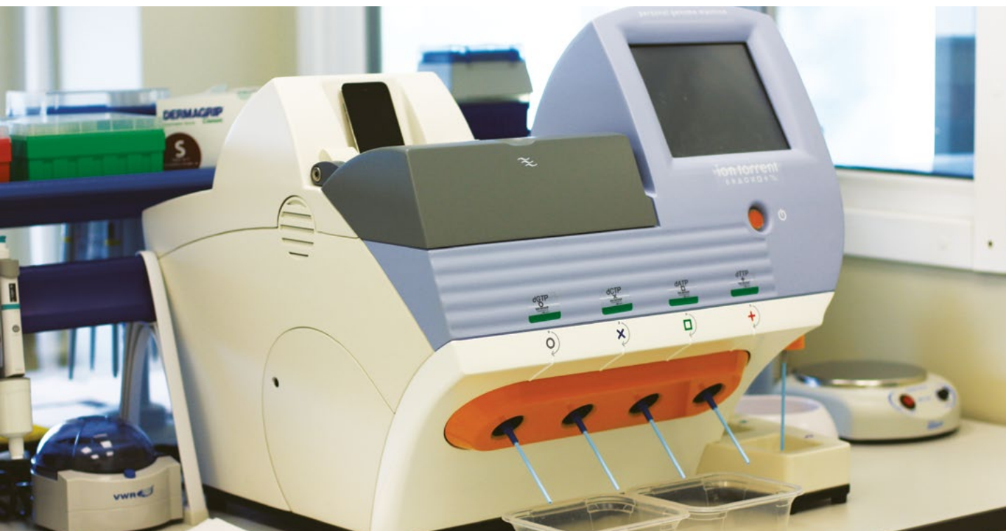
Ion PGM. Секвенаторы Life Technologies, основанные на технологии полупроводникового секвенирования, являются перспективными инструментами, способствующими внедрению технологий NGS в клиническую практику. Фото предоставлено Sequoia genetics.
