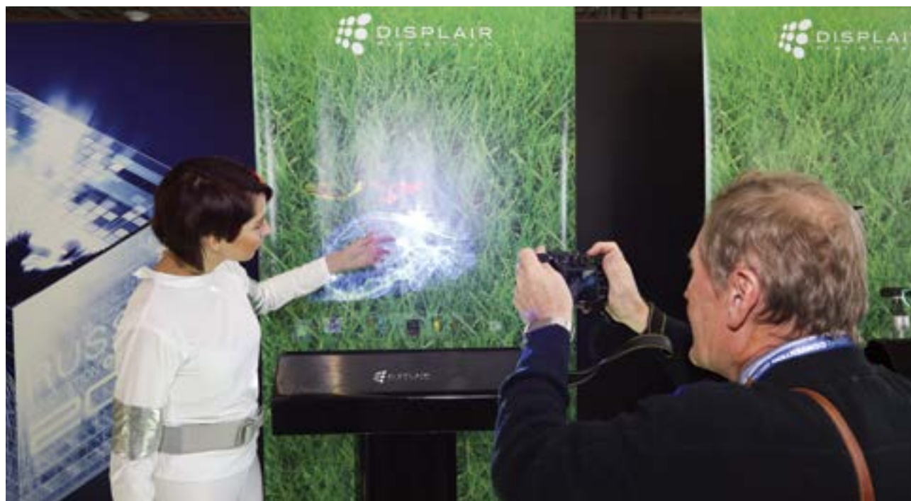
Интерактивный безэкранный дисплей на первом этаже Гиперкуба. Изображение в воздухе физически проницаемо.
